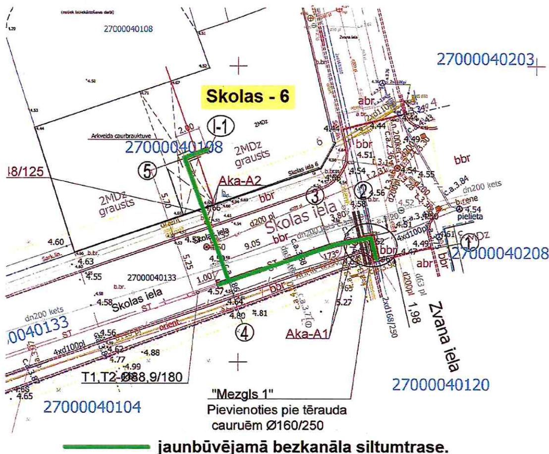
Objekta siltumtrases kopējais garums ir  $L=29,5\text{m}$ , t.sk. ārējās trases posms sastāda  $L=28,5\text{m}$ .
